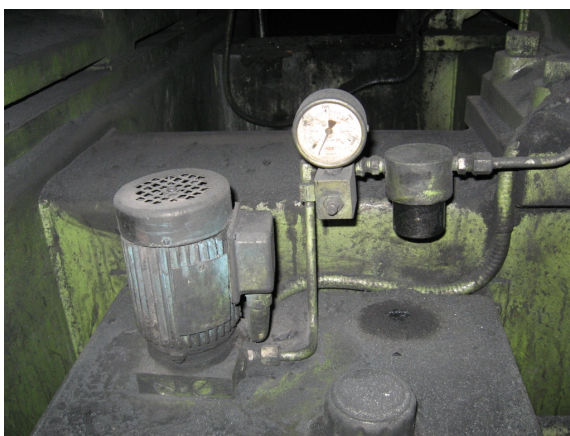
Figuras 3/4 – A filtração de óleo lubrificante para engrenagens ISO VG 460 demanda adequada seleção de filtros
