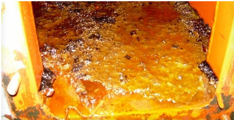
Figuras 5/6 – Deve-se avaliar o estado de filtrabilidade do óleo lubrificante para uma adequada seleção de filtro
