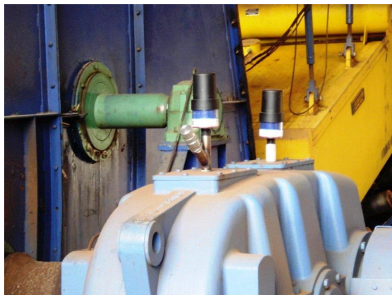
Figuras 19/20 – Reduzir o ingresso de contaminantes ao sistema é fundamental
