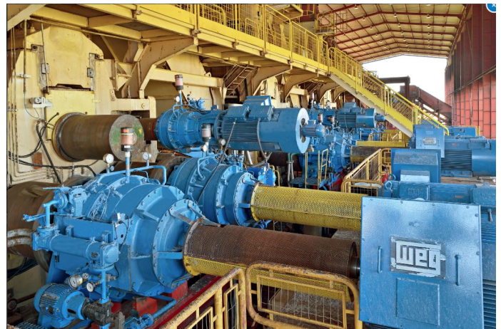
Figuras 1/2 – Redutores de velocidade com lubrificação centralizada a óleo
