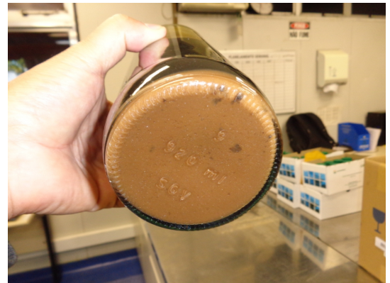
Figuras 5/6 – Deve-se avaliar o estado de filtrabilidade do óleo lubrificante para uma adequada seleção de filtro
