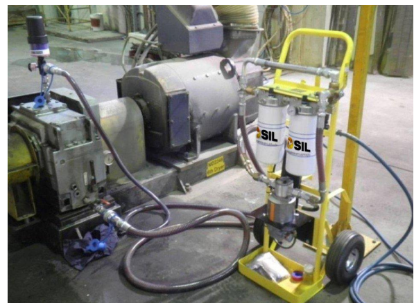
Figuras 3/4 – A filtração de óleo lubrificante para engrenagens ISO VG 460 demanda adequada seleção de filtros
