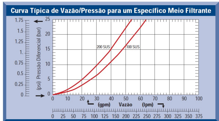
Figuras 17/18 – Foto microscópica de meio filtrante e curva P x Q
