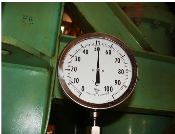
Figuras 7/8 – A temperatura em que será filtrado o óleo lubrificante deve ser verificada para a adequada seleção do filtro
