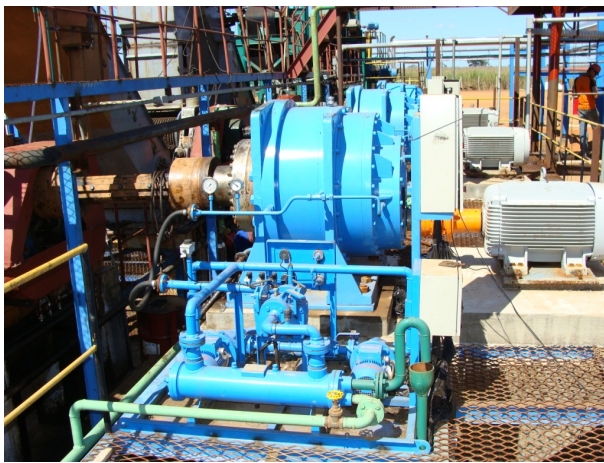
Figuras 1/2 – Redutores de velocidade com lubrificação centralizada a óleo
